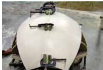
两片材料组成一组（四分之一） Seaming of 2 segments to make a quarter
